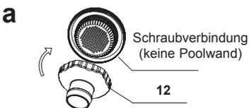
Schrauben Sie den Zschlauchanschluss B (12) von der Innenseite des Pools an die Schlauchverbindung.
