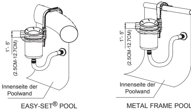
**WICHTIG:** Der Skimmer muss zu jeder Zeit vertikal bleiben, so dass der Schwimmdeckel für das Absaugen immer parallel zur Wasseroberfläche ist.
