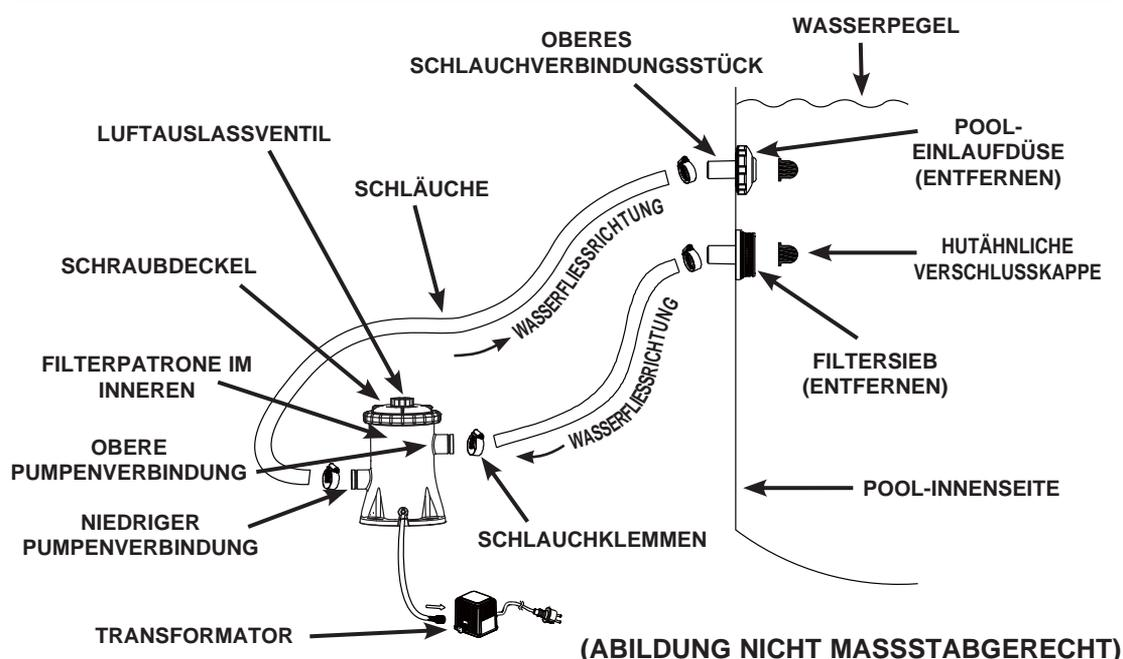
Der Netzkabelstecker der Filterpumpe für die 220-240 Volt Stromquelle muss mehr als 3,5 m von den Pool Wänden entfernt positioniert werden. Kontaktieren Sie Ihre lokalen Behörden bezüglich der entsprechenden Standards und Anforderungen zu der „Elektrischen Installation von Schwimmbädern und Beckenausrüstungen“. Die folgende Tabelle dient lediglich als Referenz.
