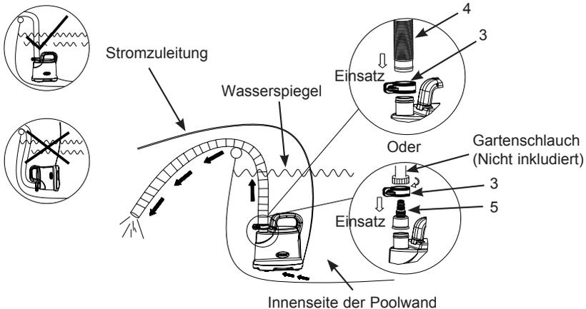
**HINWEIS:** Die maximale **Wassertiefe** im Pool darf nicht mehr als 1,22 m (48 Zoll) betragen. Um den Pumpenmotor vor dem Trockenlaufen zu schützen, ziehen Sie das Netzkabel aus der Steckdose, sobald das Wasser abgelassen ist oder wenn der Pegel des restlichen Wassers unter der Basis der Entwässerungspumpe ist.
