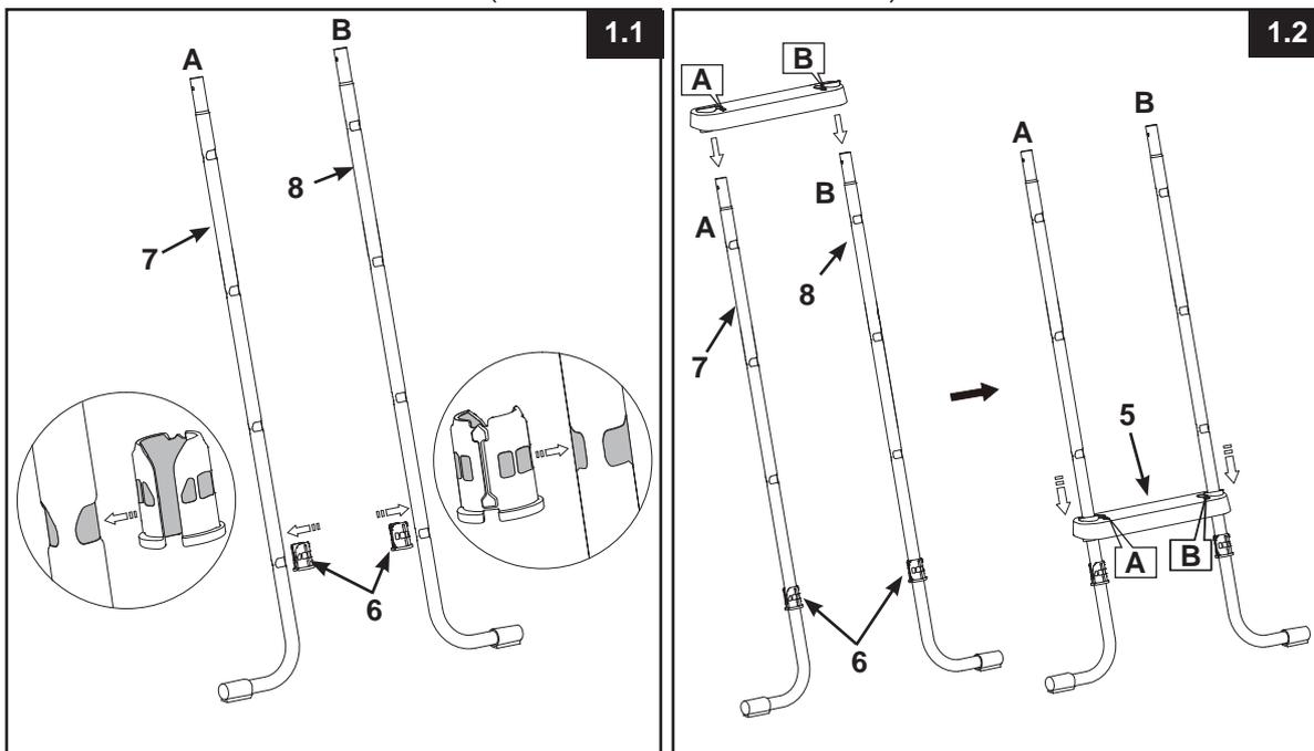
WICHTIG: Vergewissern Sie sich, dass die J-förmigen FüÙe nach auÙen schauen, bevor Sie die Stufen montieren.
