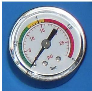
Je 1 m Höhendifferenz (Montagehöhe Oberkante Solaranlage / Filteranlage) steigt der Druck im Filterkessel um 0,1 bar. Dieser zusätzliche Druck reduziert nicht nur die Leistung der Filterpumpe sondern kann auch den Kessel im Extremfall beschädigen.
