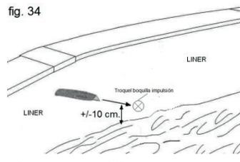
1) Nachdem der Wasserstand +/- 10 cm, Abb. 34, beträgt markieren Sie unter der unteren Ventilante mit einem Filzstift das Loch in der Verschalung und schneiden mit einem scharfkantigen Messer von der Innenwand des Pools in Richtung Außenwand die Verschalung in Kreuzform, ohne dabei über das Stanzloch zu gehen.
